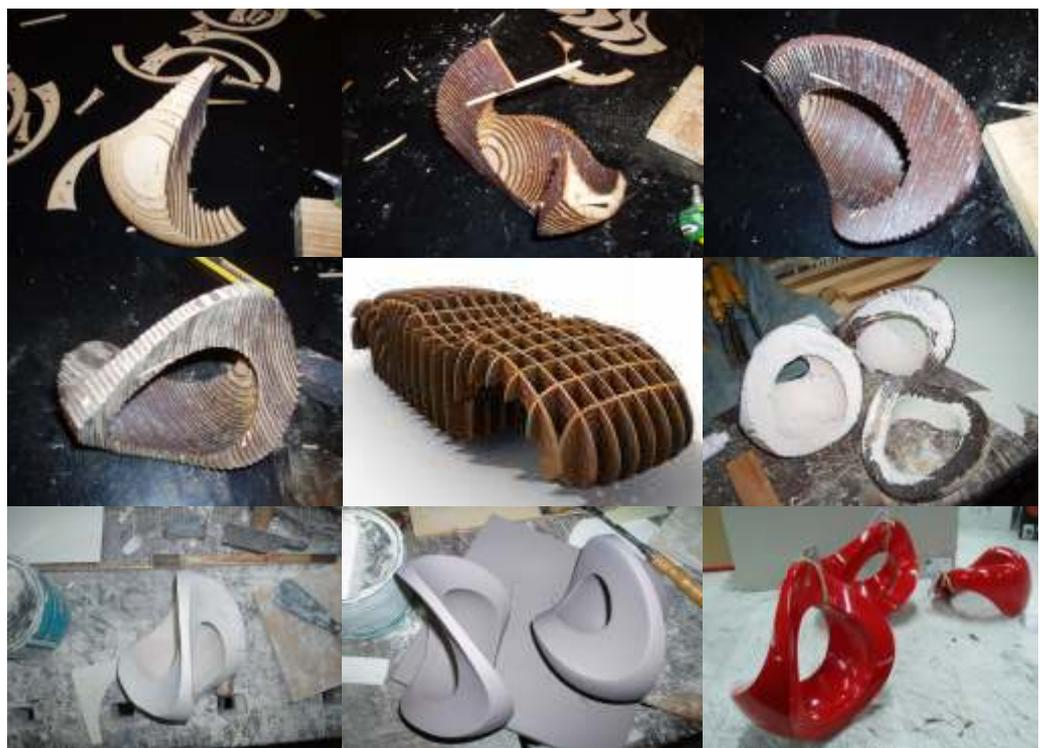
Figura 17: Proceso de Maqueta cortada por láser
