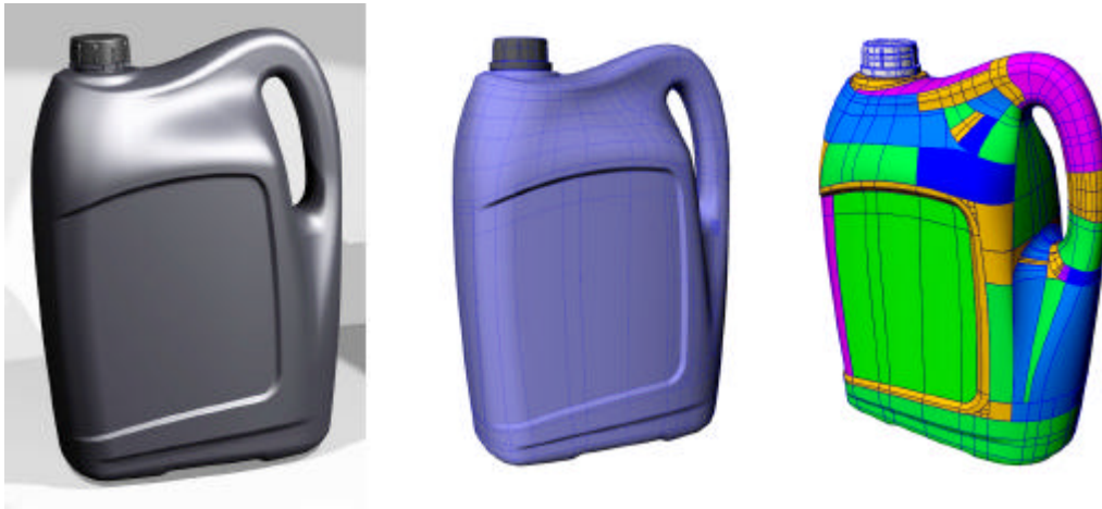
Figura 1. Imágenes de un bidón, su dibujo en malla de alambre, en sombreado y la mostración – en colores distintos- de las superficies vinculadas que configuran su forma.
