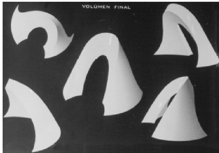
En este caso es una intersección de un cono con una superficie tórica y un cilindro.
